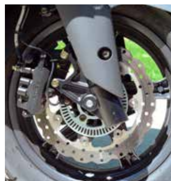
ABS, Wave remschijf en een driezuigerremklauw
