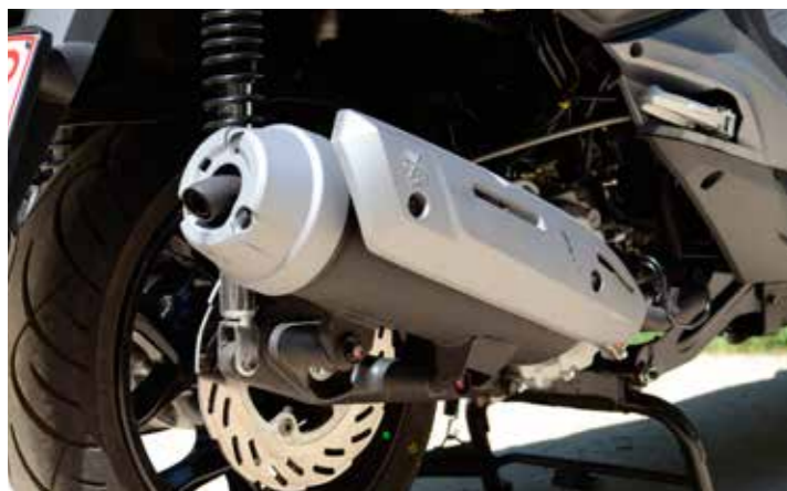
Ook de Joymax heeft achter een forse remschijf en verstelbare schokdempers
