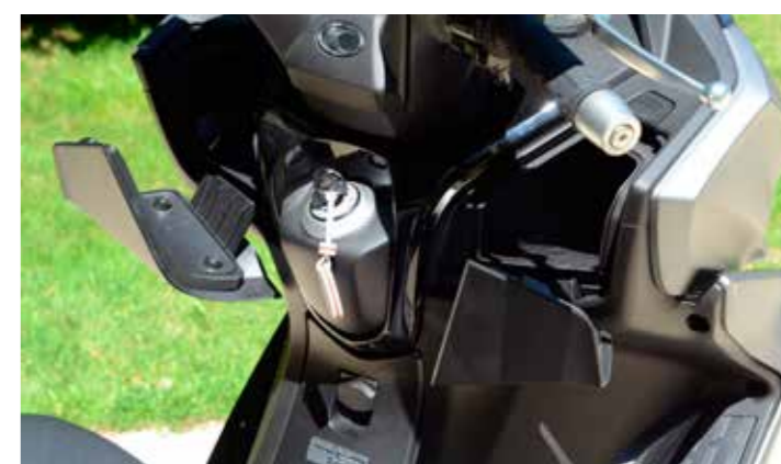
Links en rechts opbergruimte voor de extra spulletjes en een USB aansluiting
